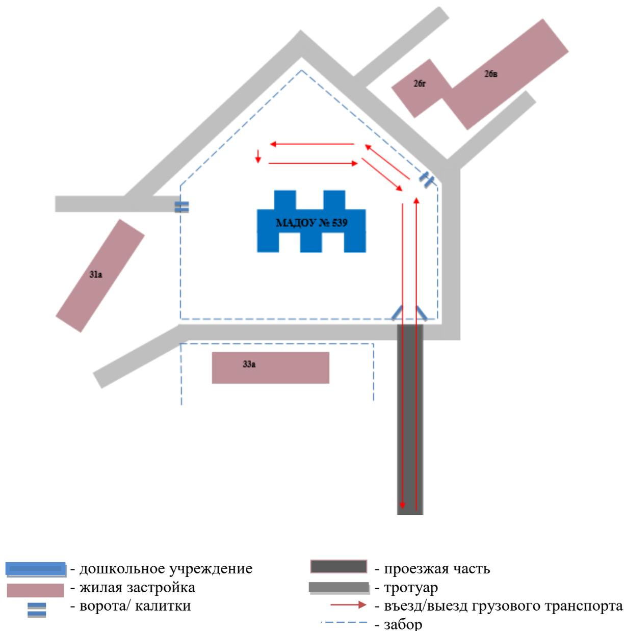
На схеме указана примерная траектория движения транспортных средств на территории МАДОУ, в том числе места погрузки/разгрузки, а также безопасный маршрут движения детей во время погрузочно-разгрузочных работ.
